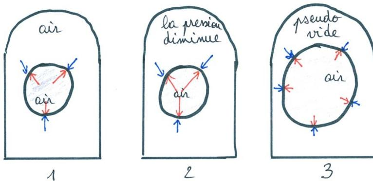
**Légende:** flèche rouge = force de l'air s'appliquant de l'intérieur du ballon, flèche bleue = force de l'air entre la cloche et le ballon qui s'exerce sur le ballon.
