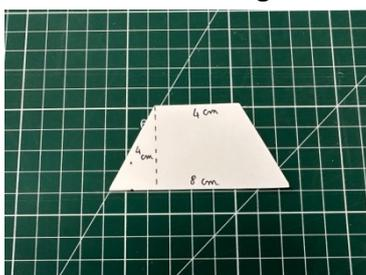
On trace les 4 ailerons sur le contre-plaqué de 3 mm et on découpe.
