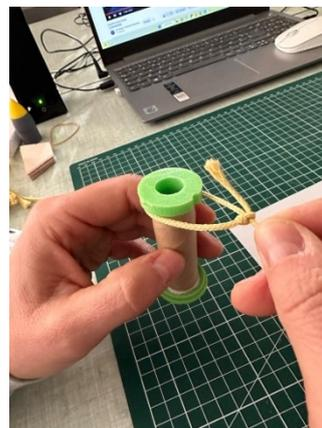
On passe la Shockcorde dans le corps de la fusée puis on fixe le support moteur ainsi que les ailerons.
